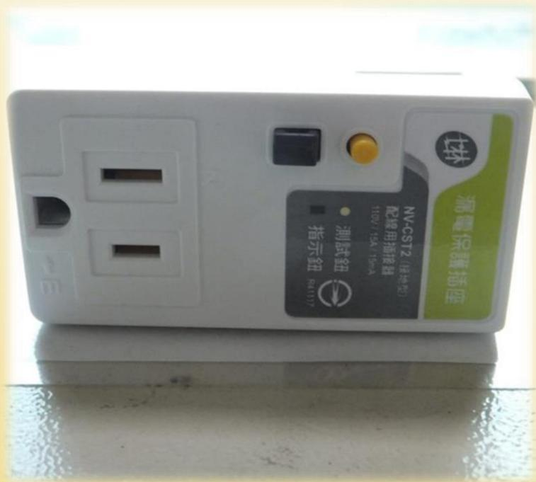
插座型漏電斷路器
